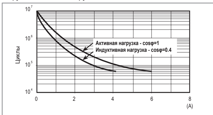
F 34 – График зависимости электрического ресурса при нагрузке AC от тока нагрузки
