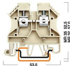
Момент затяжки / Torque: 0,4 Nm
