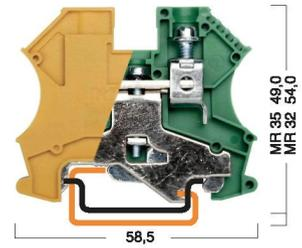
Момент затяжки / Torque: 0,5 Nm
